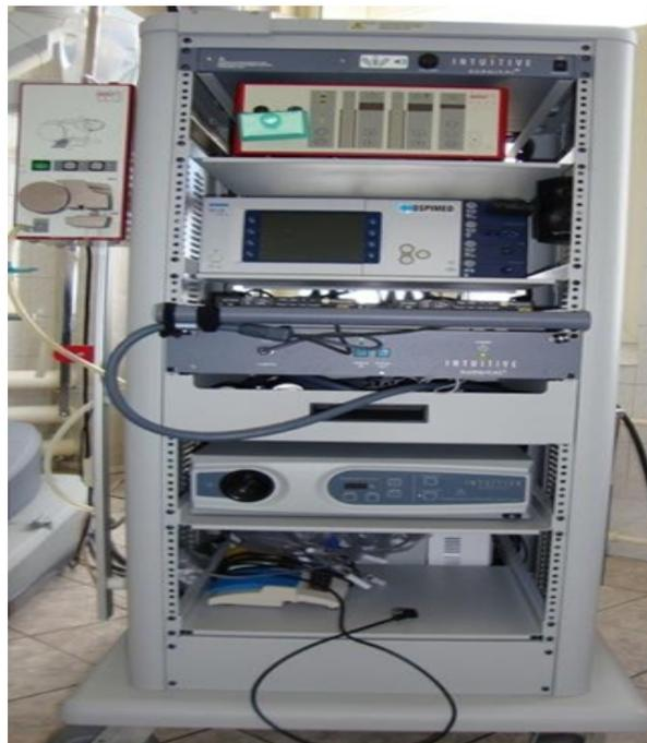
*Рисунок 2.4 – Стойка оборудования «роботической» системы «Да Винчи»*
