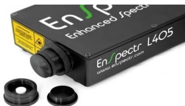
Рисунок 8.4- Прибор «ИнСпектр L405» с вкручивающимися насадками
