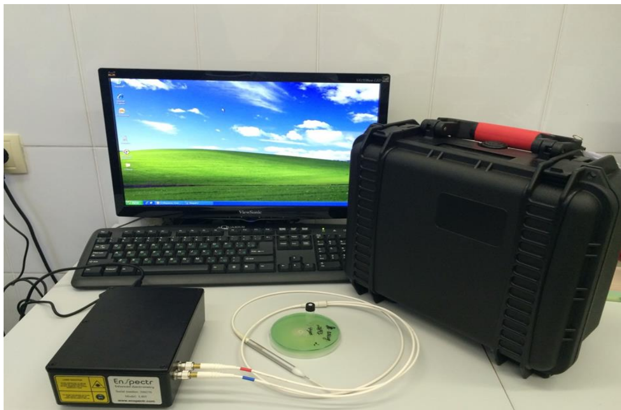
Рисунок 8.2-Люминесцентный спектрометр ИнСпектр L405 с фибером (вверху и внизу) и с вкручивающимися насадками (в центре)
