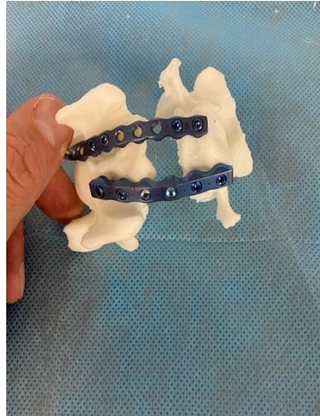
Рис. 3.3.2.2. Имитаторы шейных позвонков. Вентральный доступ. 2 параллельные пластины и по 4 монокортикальных винта в каждый позвонок
