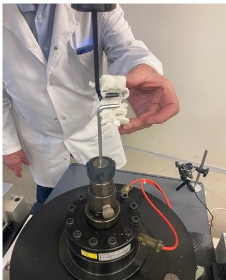
Рис. 3.3.2. Процесс закрепления образца в специальной оснастке
