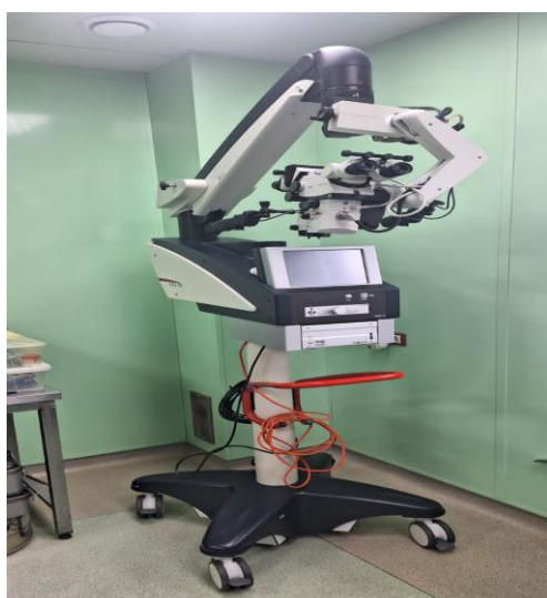
Рис 2.2.11. Микроскоп Лейка525, увеличение X26
