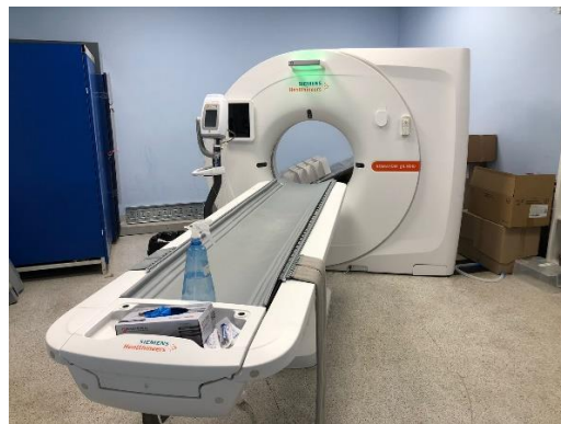
Рис. 2.2.2. КТ аппарат Siemens Somatomedion go.Now 16 срезов
