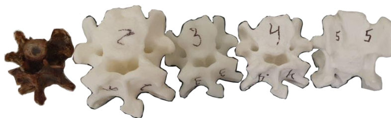
Рис. 3.2.1.5. Фотография образцов: 1 – нативный позвонок собаки, 2-5 – имитаторы позвонка животного
