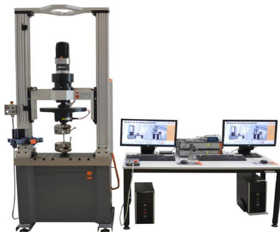
Рис. 3.2.1.1. Внешний вид испытательной установки LFM-50
