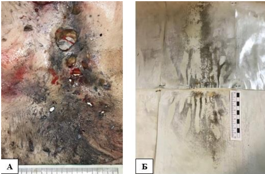
Рисунок 4.24. Полосовидный характер участка распределения повреждений «Лоскута» при выстреле «Картечью» по «Металлу», угол встречи 50 градусов: макроскопическая картина (А), контактограмма – отложения свинца темно-коричневого цвета (Б).
