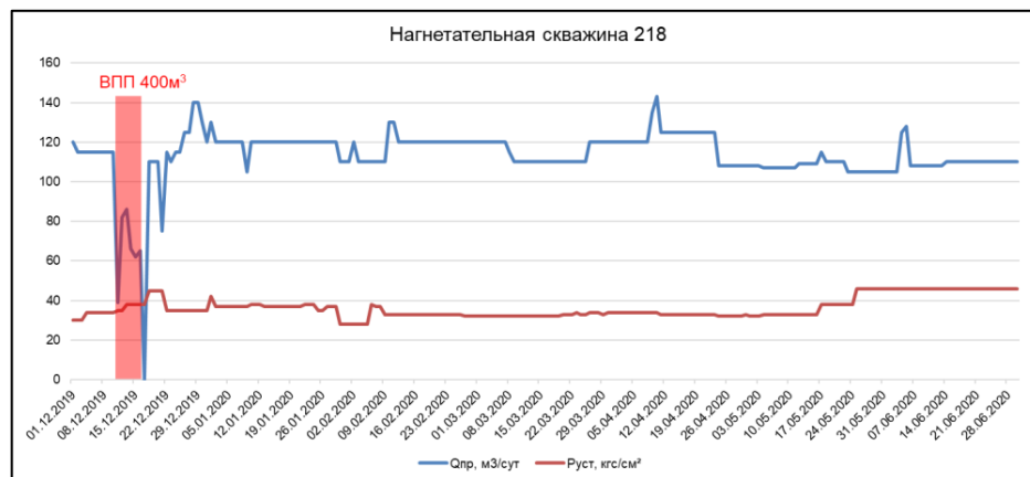
Рис. 6.8. Динамика приемистости Q_{пр} (м 3 /сут) и устьевого давления P_{уст} (0,1 МПа) в нагнетательной скважине 218 после закачки 400 м 3 реагента (построена автором по данным ДТОО «ЖАЛГИЗТОБЕМУНАЙ»)
