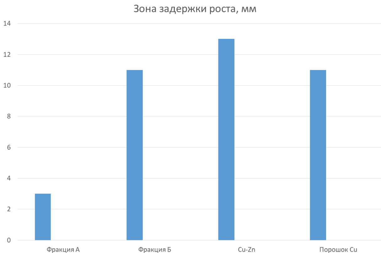
Рис 4.6. Зоны ингибирования подготовленных частиц Cu-Zn.
