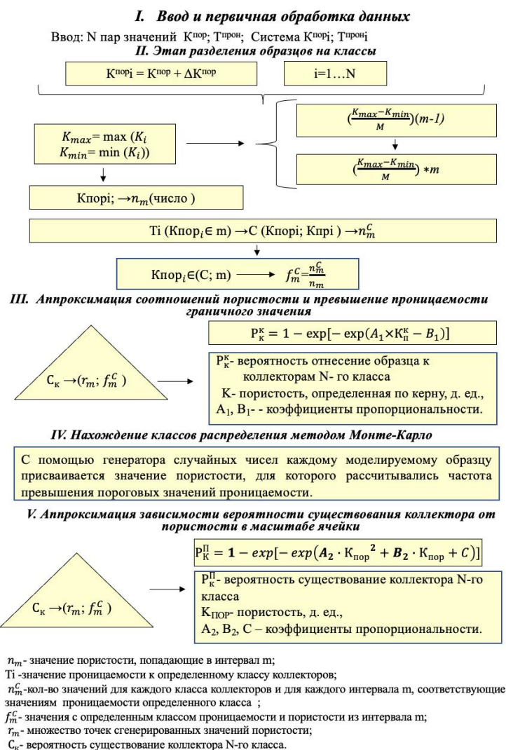
Рисунок 6 – Принципиальная блок-схема программы определения зависимости вероятности существования коллекторов определённого класса от пористости, св. ЭВМ № 2022611634
