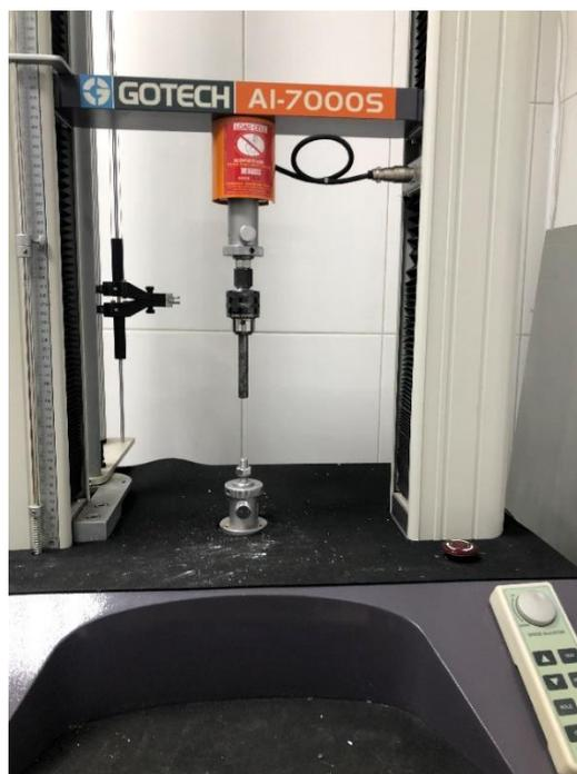
Рис. 2.10. Испытательная машина GT-AI7000-S
