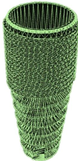
Рисунок 3.23. - Компьютерная модель предлагаемого имплантата конической формы
