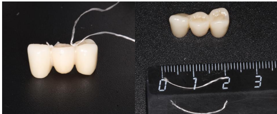
Рисунок 25 - Измерение периметра перемычек с помощью флосса
