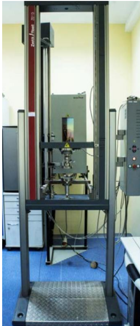
Рисунок 5 - Универсальная испытательная машина Zwick/Roell Z010
