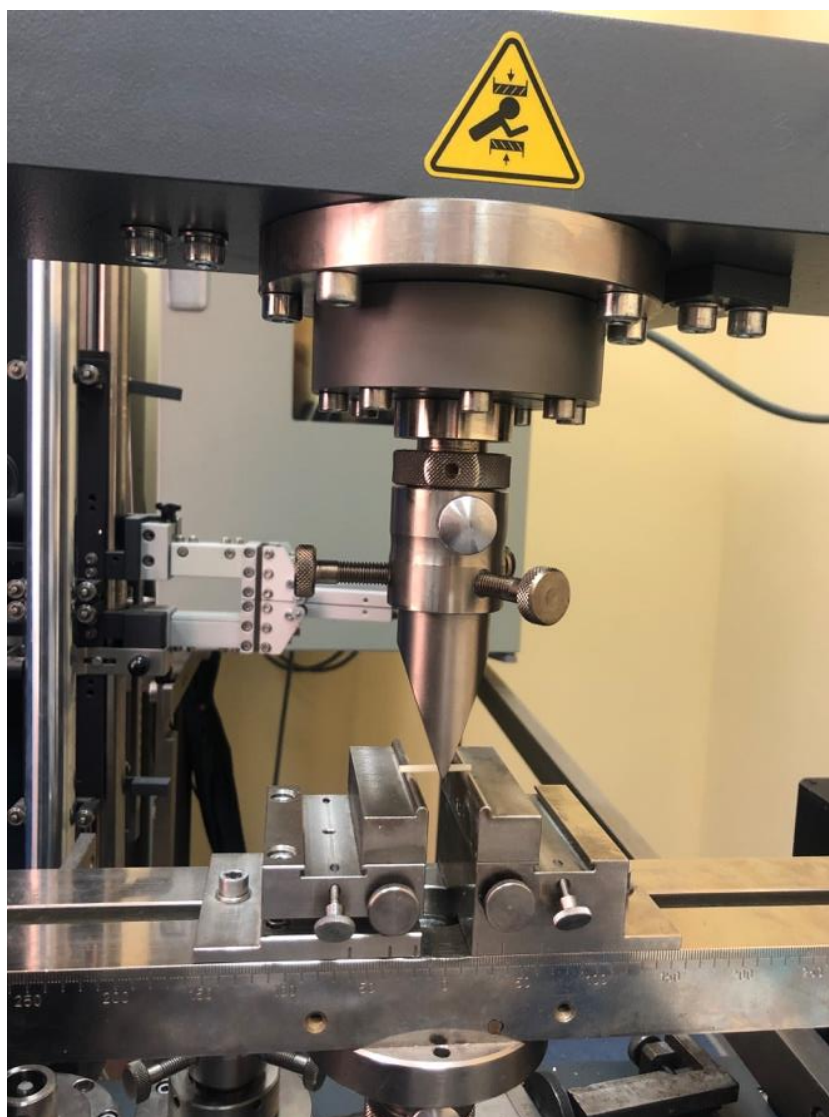
Рисунок 6 - Испытания на прочность при изгибе (методом трехточечного изгиба) на универсальной машине Zwick/Roell Z010 образца из предварительно окрашенного диоксида циркония Zisceram T (Циркон Керамика, Санкт-Петербург, Россия) цвет А2. Обжиг образцов проводили в печи Zubler Vario S400 (Zubler, Германия).
