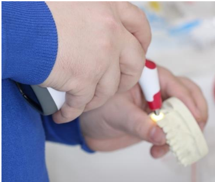
Рисунок 16 - Измерение параметров цвета полированной диоксидциркониевой коронки, спектрофотометром Easy Shade V (VITA Zahnfabrik, Германия)
