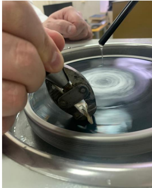
Рисунок 12 - Изготовление фаски на отполированных образцах
