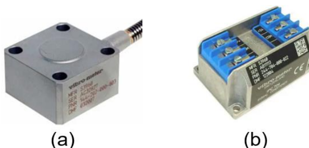
Рисунок 3 – Оборудование, используемое для измерения скорости вибрации турбин на газовой электростанции Киркука: (а) – акселерометр СА 202, (б) – преобразователь сигналов IPC 704 преобразует сигнал, основанный на заряде от пьезоэлектрического преобразователя, в сигнал тока или напряжения
