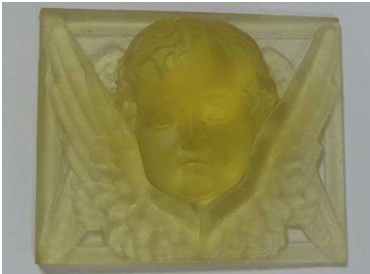
Рисунок 109 – Выращенная уменьшенная копия головки херувима с помощью 3D-принтера Objet Eden 350V. 2008 г.
