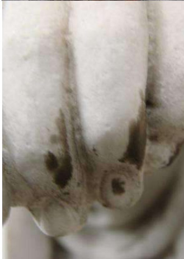
Рисунок 103 – Корковый вид разрушения мраморной скульптуры. Начальная стадия формирования чёрной корки
