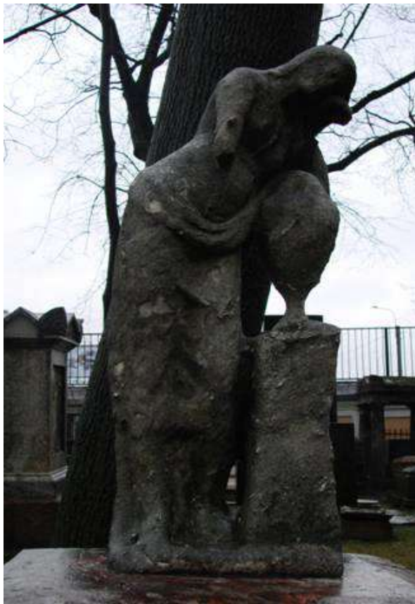
Рисунок 102 – Эрозионный вид разрушения мраморной скульптуры, приведший к утрате скульптурных объёмов
