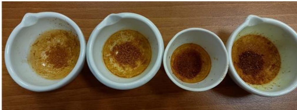
**Рисунок 34.** Остаток после высушивания в образцах отваров из дерезы обыкновенной (слева направо - время настаивания при  $t=15, 30, 45$  и  $60$  мин.
