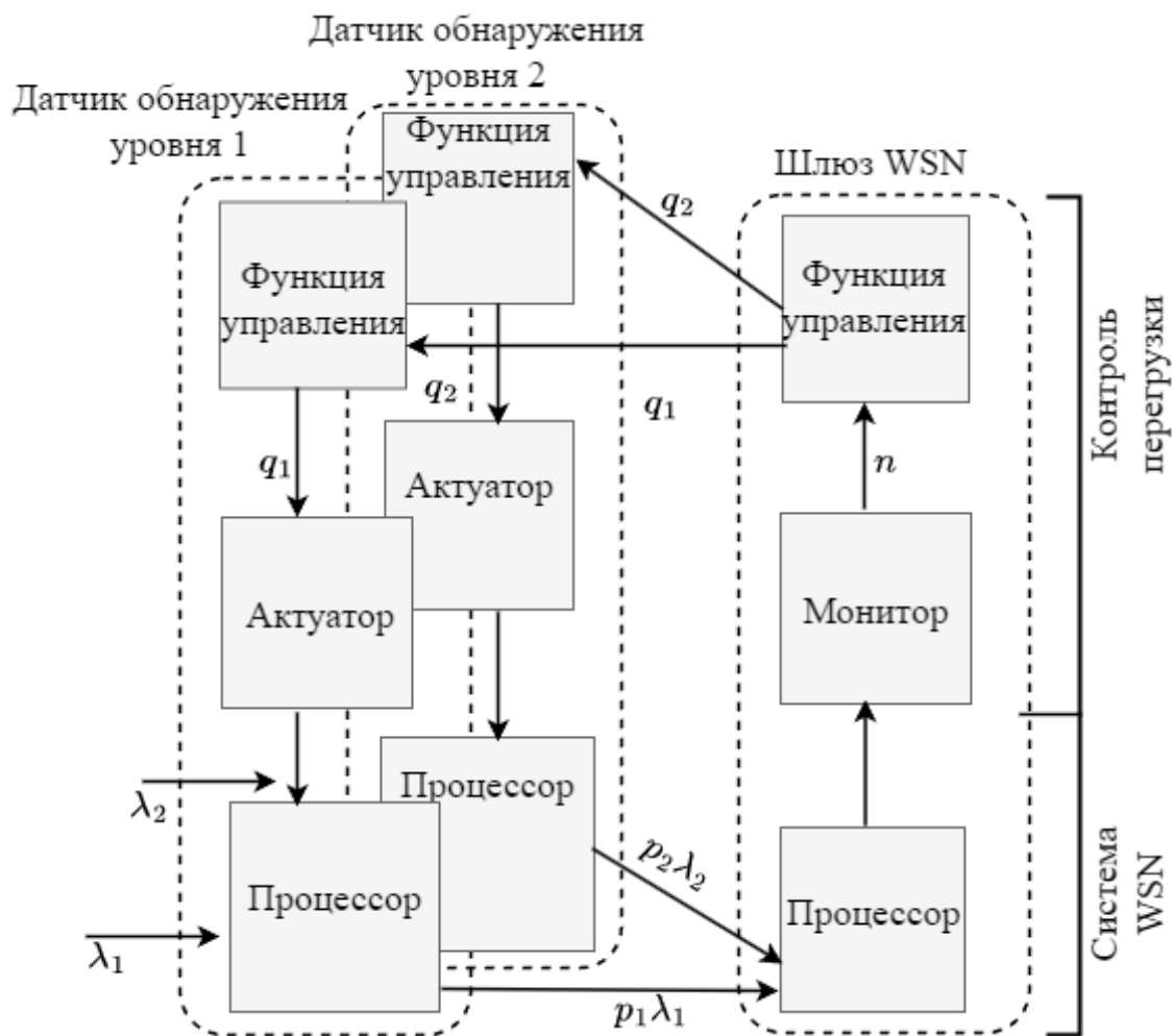
Рис. 1.8. Схема системы контроля перегрузки
