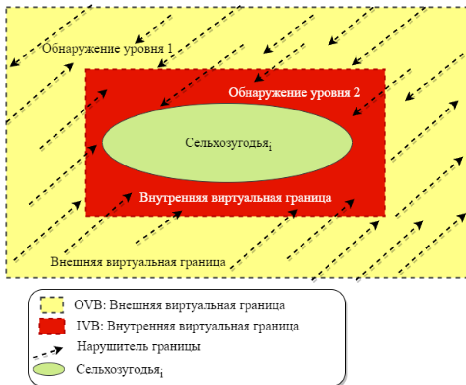
Рис. 1.5. Схема системы обнаружения вторжений на сельхозугодья.
