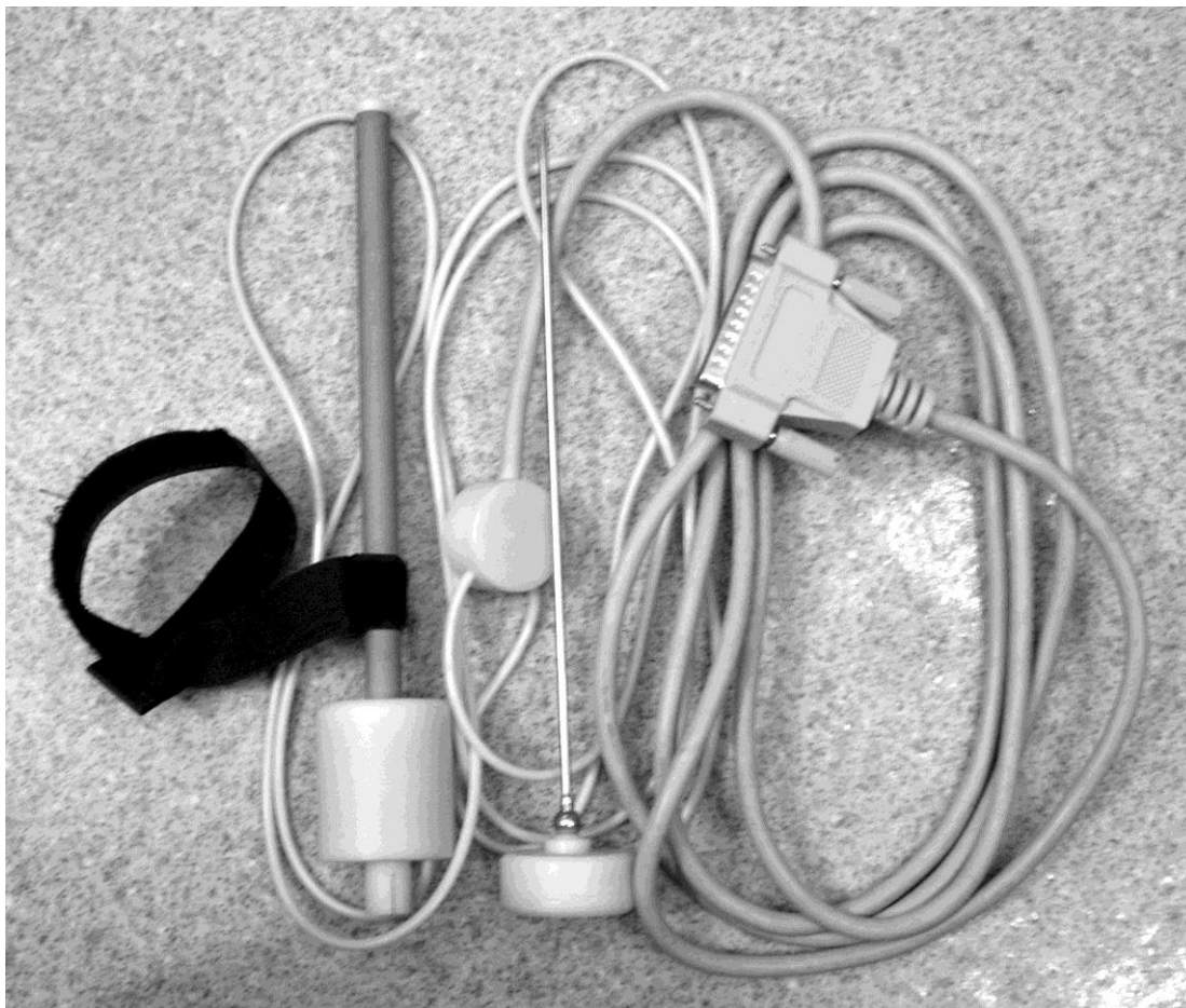
Рис. 2.1. Термоизмерительная приставка к компьютеру, включающая игольчатый щуп для измерения температуры в глубоких отделах трупа и датчик для измерения температуры окружающего воздуха
