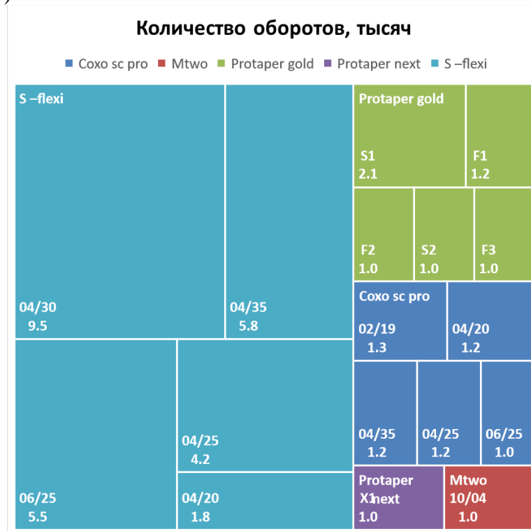
Рисунок 6 – Диаграмма, отображающая степень устойчивости исследуемых инструментов к нагрузкам по времени функционирования инструментов до момента отлома (среднее значение для группы, N = 3)
