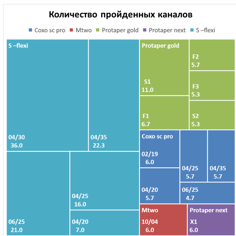
Рисунок 4 – Диаграмма, отображающая степень устойчивости исследуемых инструментов к механической нагрузке по количеству пройденных каналов (среднее значение для группы, N = 3)
