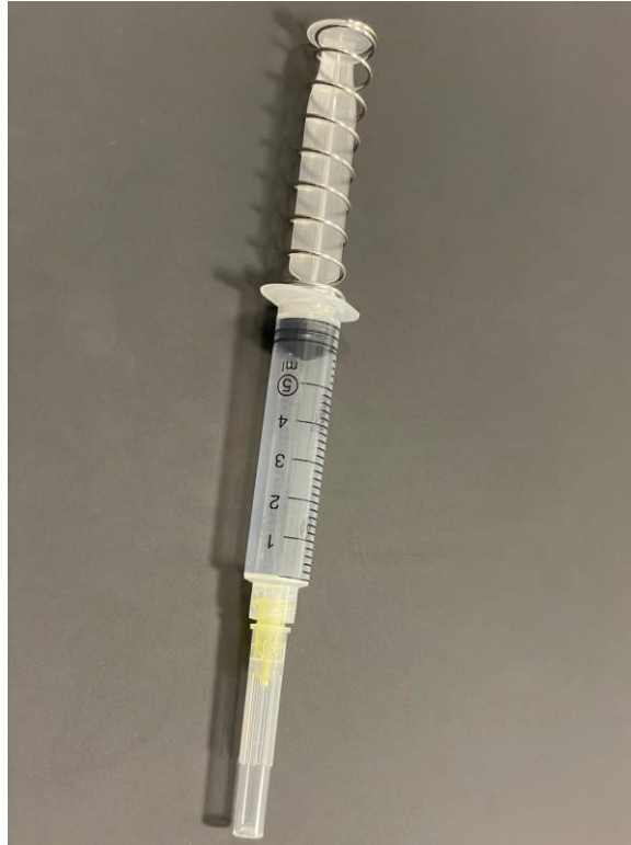
Рисунок 1 – Шприц с пружинящим поршнем и иглой 30G
