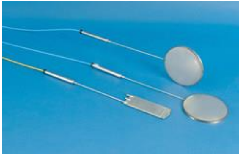
Рисунок А-3.4. Датчики давления на грунт
