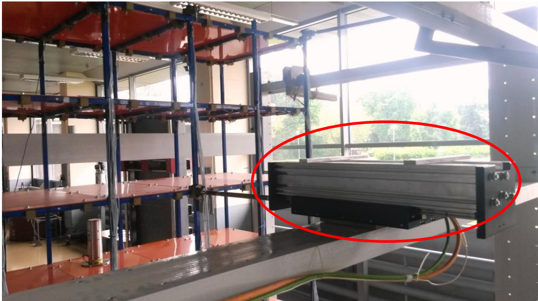
Рисунок Б.4. Линейный двигатель для моделирования динамических нагрузок
