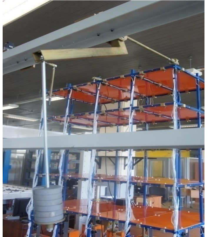
Рисунок Б.3. Рычажная система для моделирования кренов
