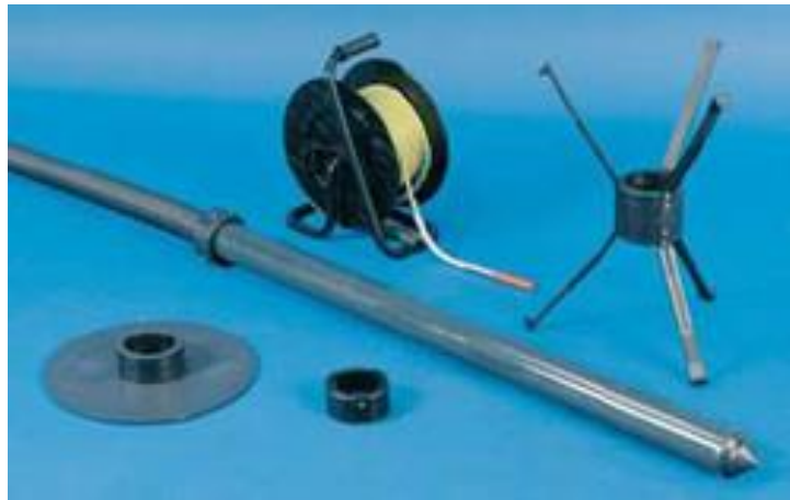
Рисунок А-3.1. Система контроля послойных осадок грунта
