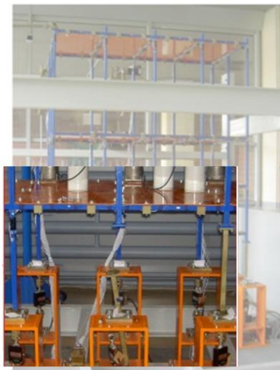
Рисунок Б.5. Возможность проведения экспериментальных исследований с удалением опор
