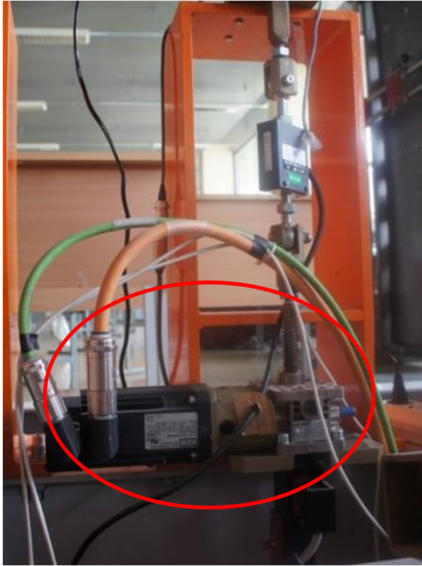
Рисунок Б.2. Винтовой домкрат для моделирования осадки опор модели
