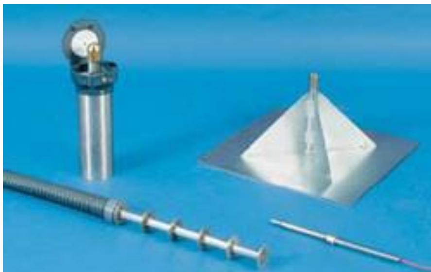
Рисунок А-3.2. Система контроля суммарных осадок грунта
