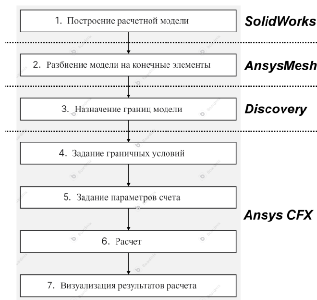
Рисунок 4.1 - Схема процесса моделирования.
