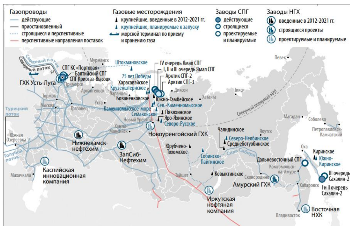
Рисунок 1.7 - Схема газовой промышленности и системы магистральных газопроводов России
