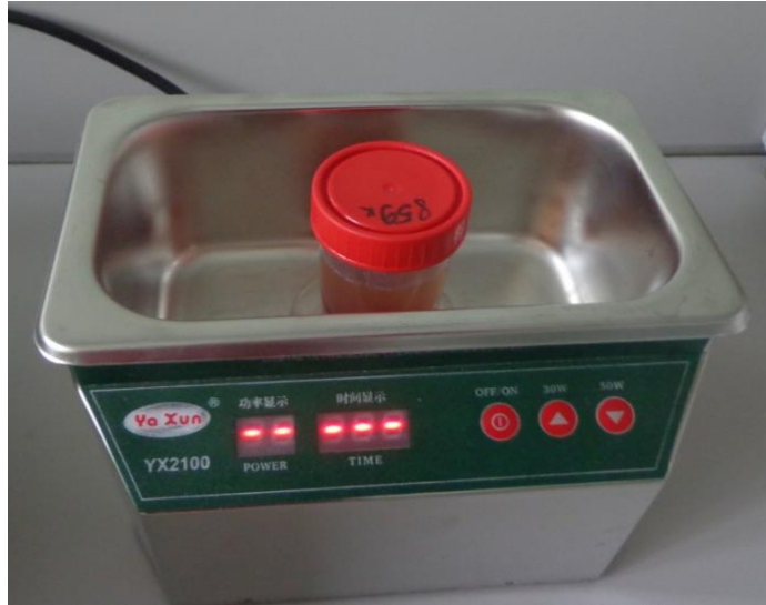
Рисунок 3 – Контейнер с головкой эндопротеза в стерильном физиологическом растворе в ультразвуковой камере YX 2100
