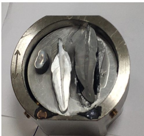
Рисунок 3 - Продольный шлиф зуба, покрытый Au толщиной 20 нм. Образец 2.6, 2.7
