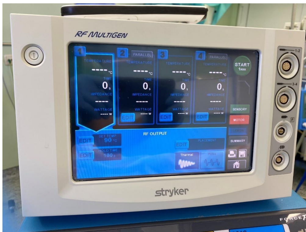
Рисунок 3.7 - Установки температуры и временной экспозиции на радиочастотном генераторе Stryker Interventional spine MultiGen RF Console
