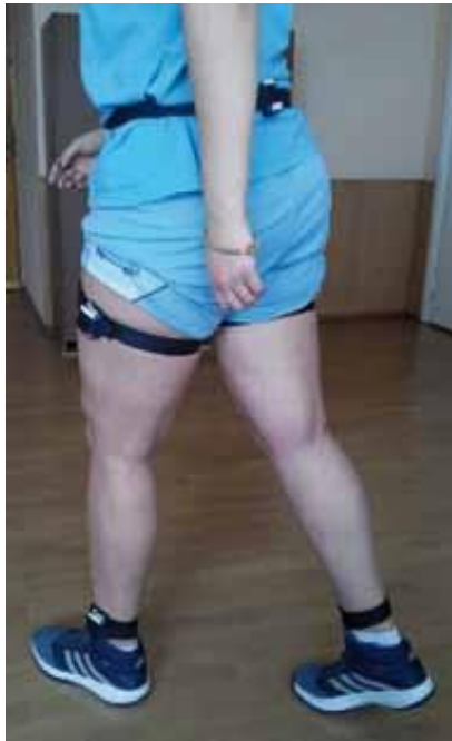
Рисунок 2.8 - Исследование биомеханики походки с помощью безплатформенных инерционных сенсоров
