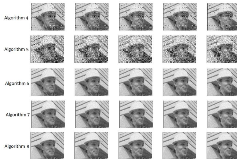
Рисунок 13. Восстановленные отдельные кадры видео Foreman, полученные при тех же параметрах. Наблюдается лучшее качество реконструкции у предложенных одношаговых алгоритмов
