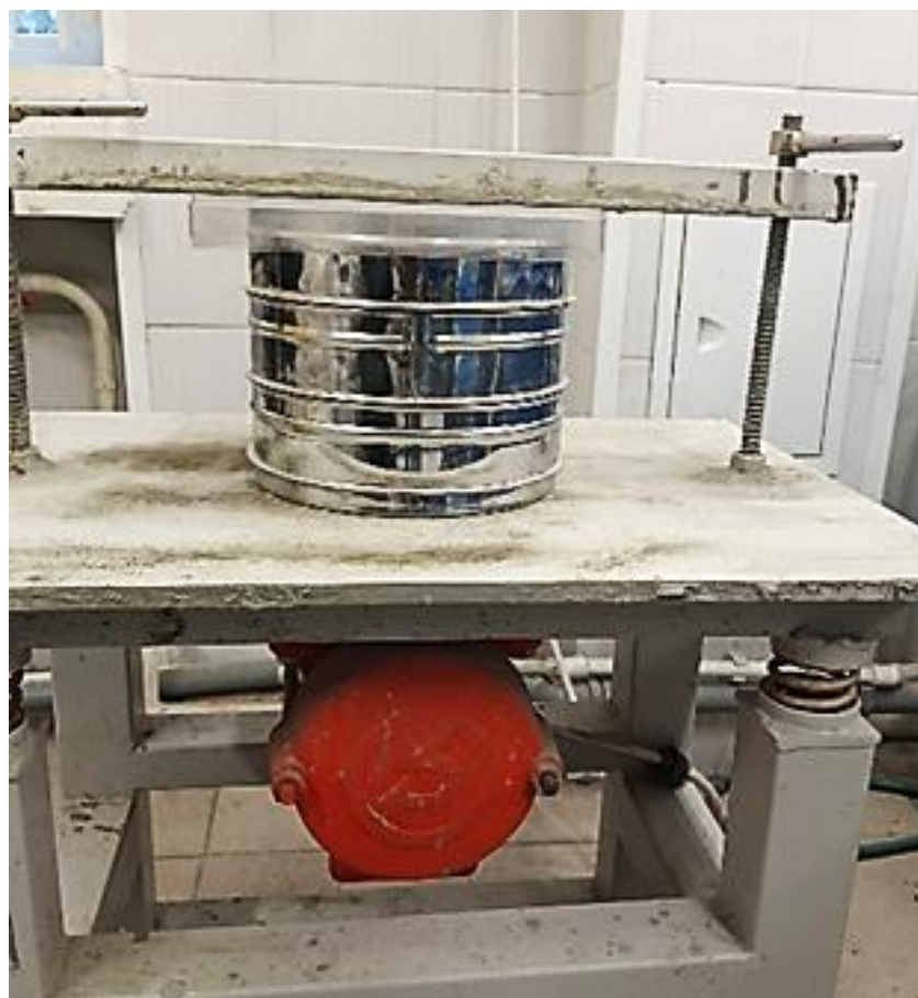
Рисунок 2.4 – Вибростол с лабораторным набором сит
