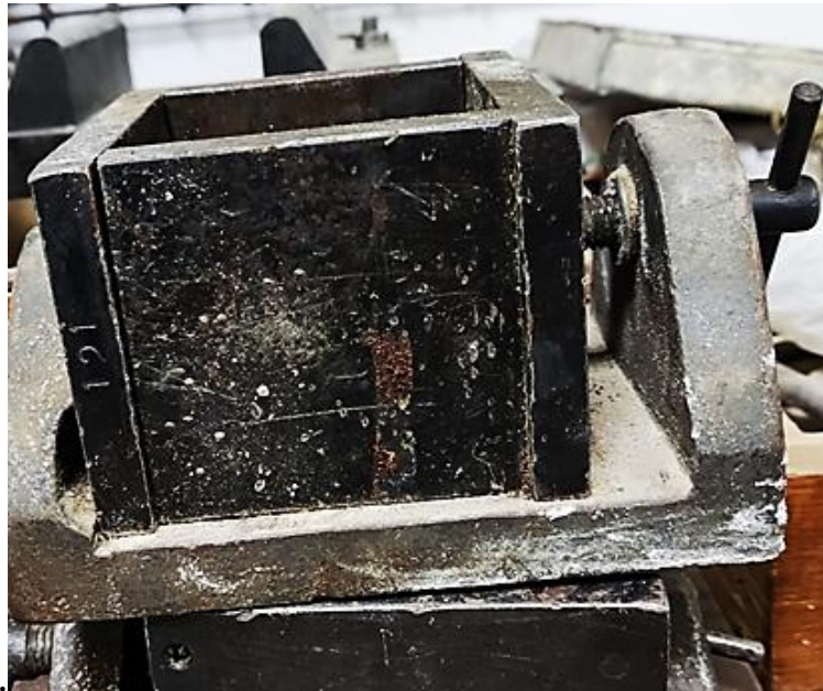
Рисунок 2.8 – Разъемная форма для заливки бетонной смеси
