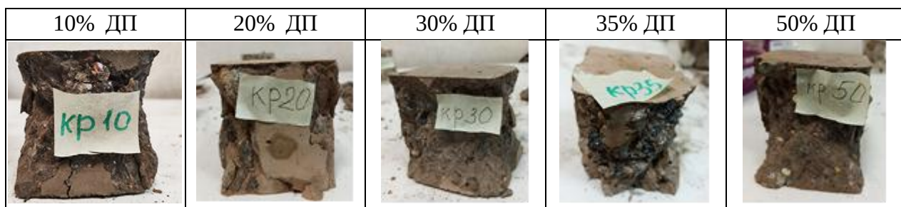
Рисунок 4.3 – Фотографии разрушений образцов бетона с различным процентным содержанием ДП №3
