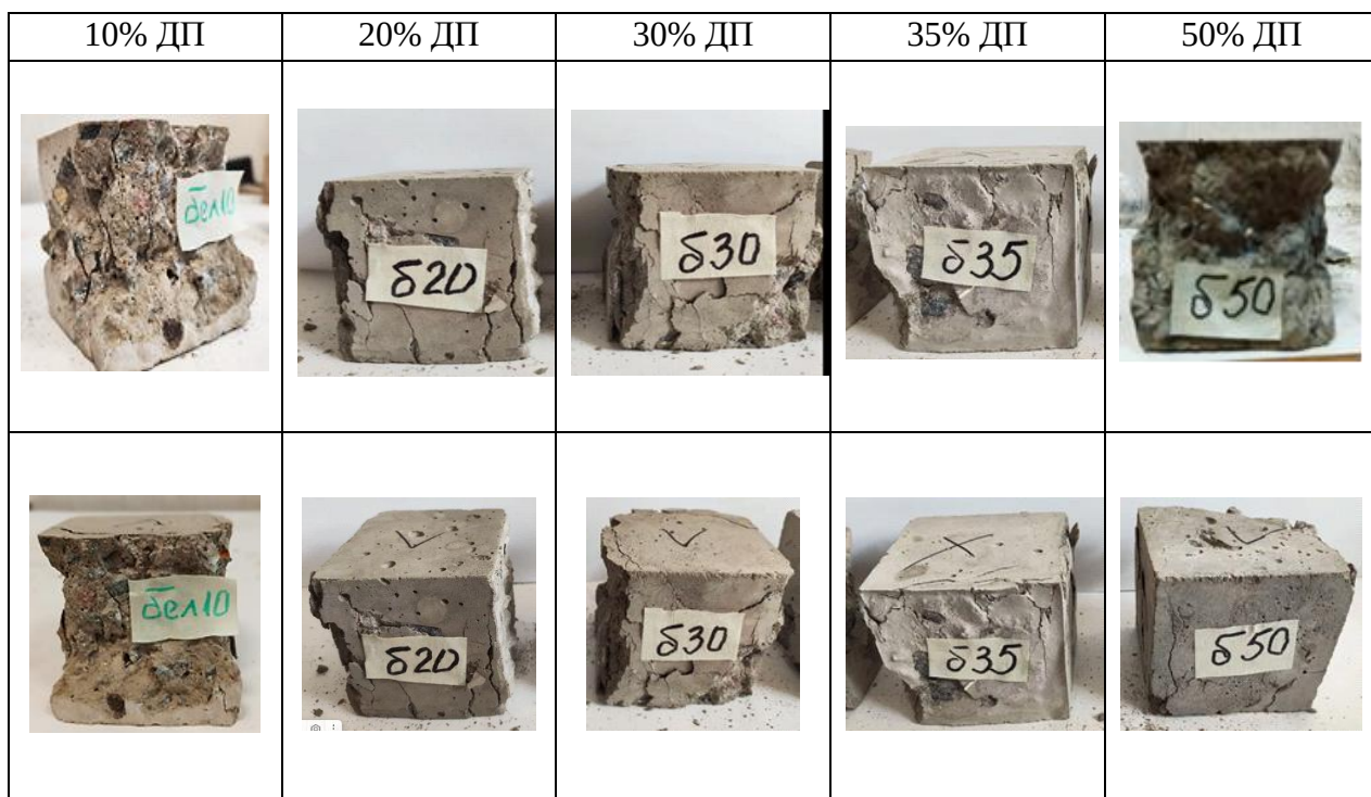
Рисунок 4.2 – Фотографии разрушений образцов бетона с различным процентным содержанием ДП №2
