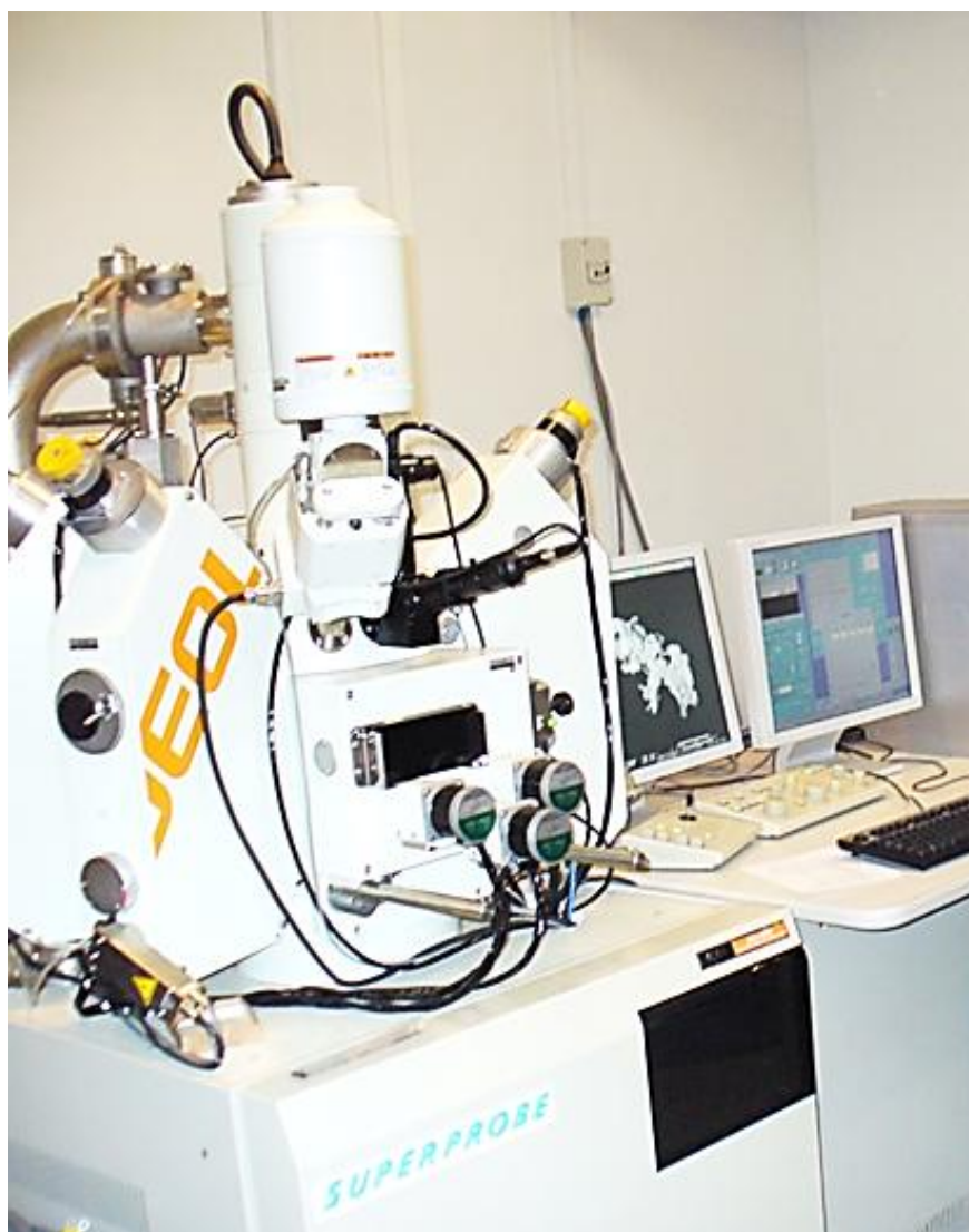
Рисунок 2.7 – Аппарат рентгеноспектрального микроанализа типа SUPERPROBE
