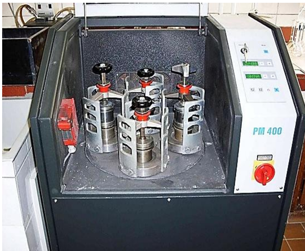
Рисунок 2.3 – Планетарная мельница типа РМ-400
