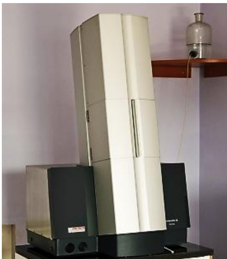
Рисунок 2.6 – Лазерный анализатор FritschParticleSizer «Analysette 22»
