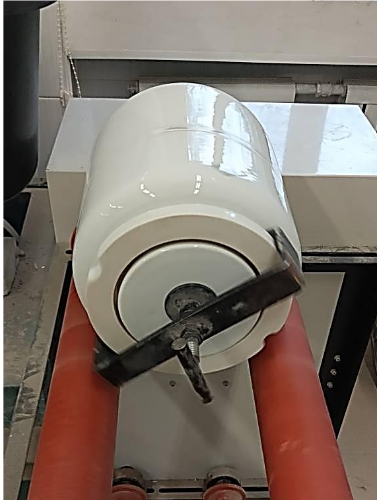
Рисунок 2.2 – Мельница типа WiseMix BML-2
