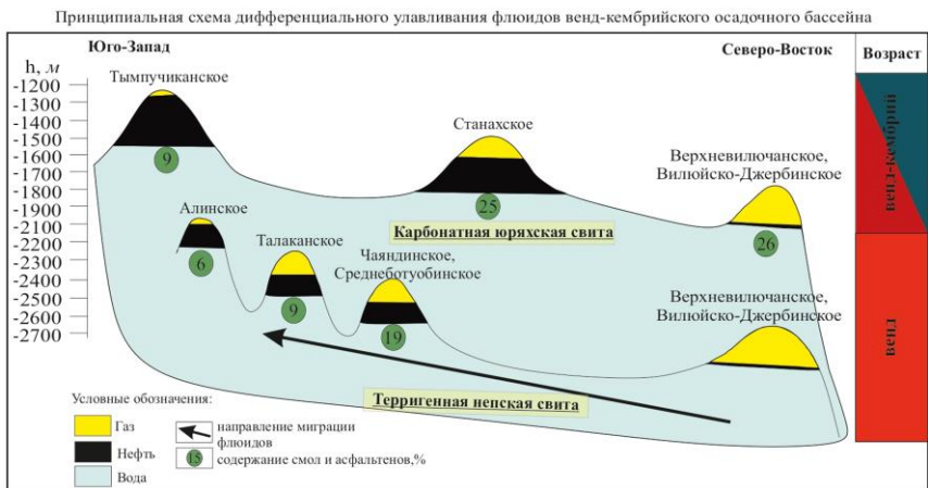
Рисунок 3.1. Принципиальная схема дифференциального улавливания флюидов венд-раннекембрийского осадочного бассейна. Составлено автором.
