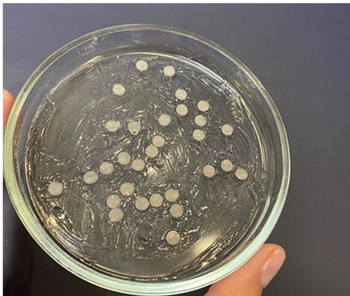
Рисунок 11 – Образцы конструкционного материала используемого в технологии производства лицевых протезов после окончательной фотополимеризации в глицериновом геле.
