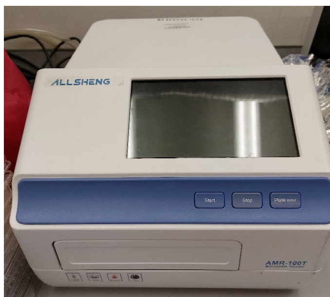
Рисунок 9 – Микропланшетный ридер AMR-100T (Allsheng, КНР)
