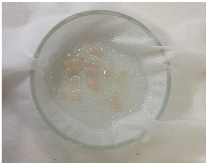
Рисунок 10 – Постпечатная обработка образцов конструкционного материала используемого в технологии производства лицевых протезов в этиловом спирте.
