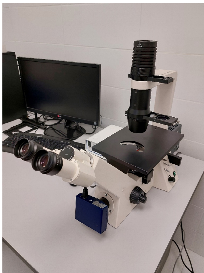
Рисунок 6 – Инвертированный микроскоп Axiovert 40 CFL (Zeiss, Германия).
