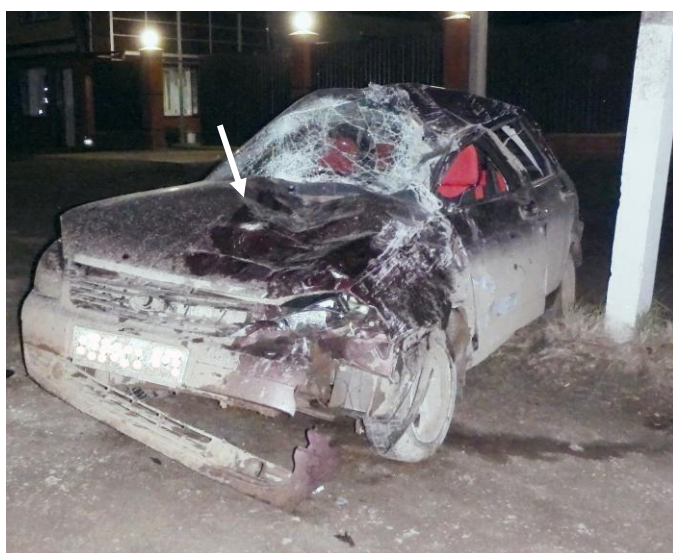
Рисунок 7.28 – Повреждения кузова автомобиля. Стрелкой указан разрыв крышки капота
