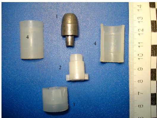
Рисунок 7.3 – Составные части патрона "ПУЛЯ ПОЛЕВА-3". 1 – пуля; 2 – стабилизатор; 3 – обтюратор; 4 – "лепестки" контейнера
