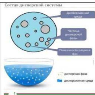
Дисперсная фаза (ДФ) - совокупность диспергированных частиц, размеры которых больше молекулярных. Дисперсионная среда (ДС) - однородная непрерывная фаза, в которой возможен переход из одной точки в другую без выхода за пределы этой фазы.
