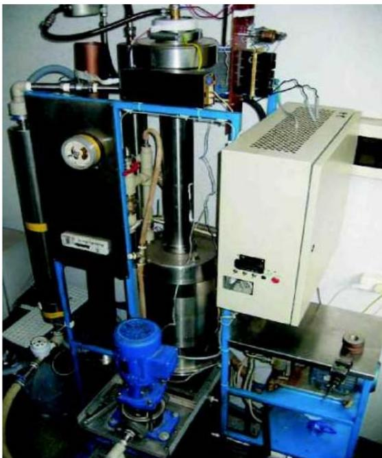
Установка плазменной очистки воды. Фото из архива
