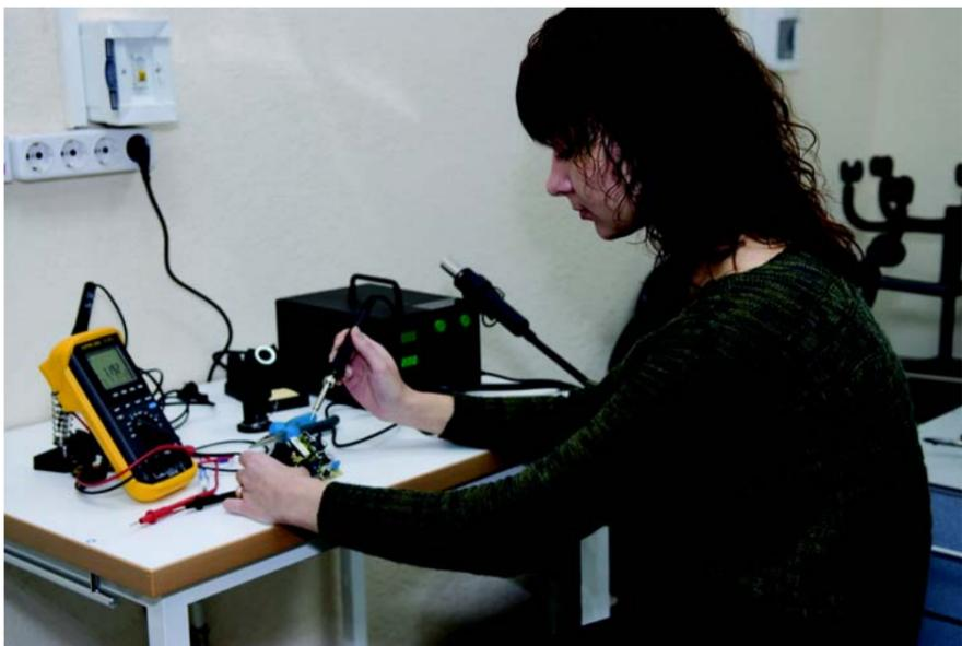
Работа на паяльной станции – монтаж измерительных датчиков. Фото В. Сиволапа
